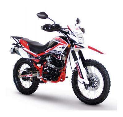
MOTOR : MONOCILINDRICO, OHV,4 TIEMPOS EMFRIADO POR AIRE
